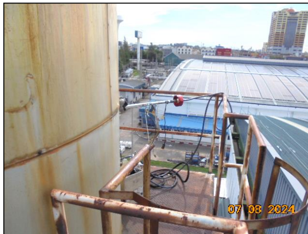
รูปที่ 3.1 การเก็บตัวอย่างคุณภาพอากาศในปล่องระบาย บริเวณ ปล่องควันของเตาหลอม
