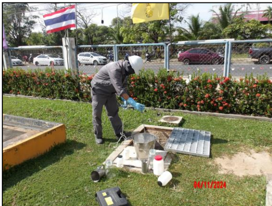
รูปที่ 3.4 การเก็บตัวอย่างคุณภาพน้ำทิ้ง บริเวณจุดปล่อยน้ำเสียของโครงการลงสู่ท่อรับน้ำเสียรวมของนิคมอุตสาหกรรมแหลมฉบัง
